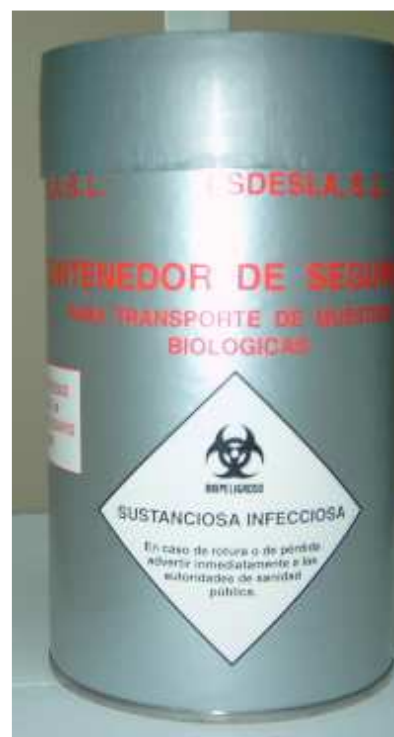
Contenedor de seguridad para transporte de muestras biológicas
