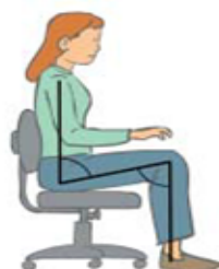
Figura 1. asiento muy alto, produce molestias en rodillas y empeine. Indicado Poner reposapiés
