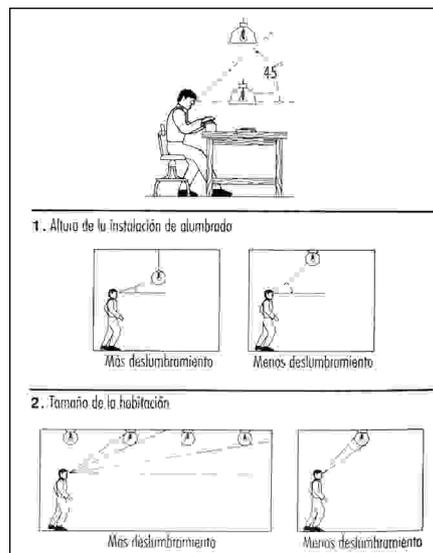
Figura 1. Factores que afectan al deslumbramiento.
